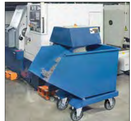
Exemple d'utilisation: Comme collecteur de copeaux de coupe
